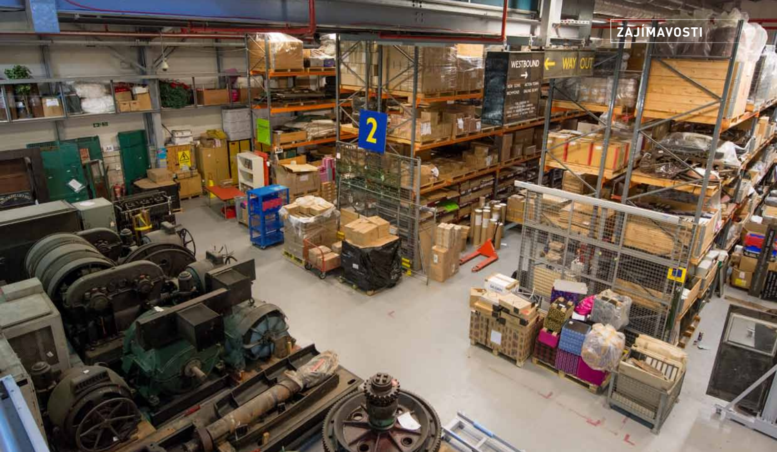
Nahoře: Pohled z galerie (v plánu č. 7) na uspořádání skladovacích ploch pro technologické vybavení (původem především z věhlasné londýnské podzemní dráhy). Větší předměty jsou skladovány na paletách na zemi, středně velké předměty se skladují v regálových systémech se zakladači.
