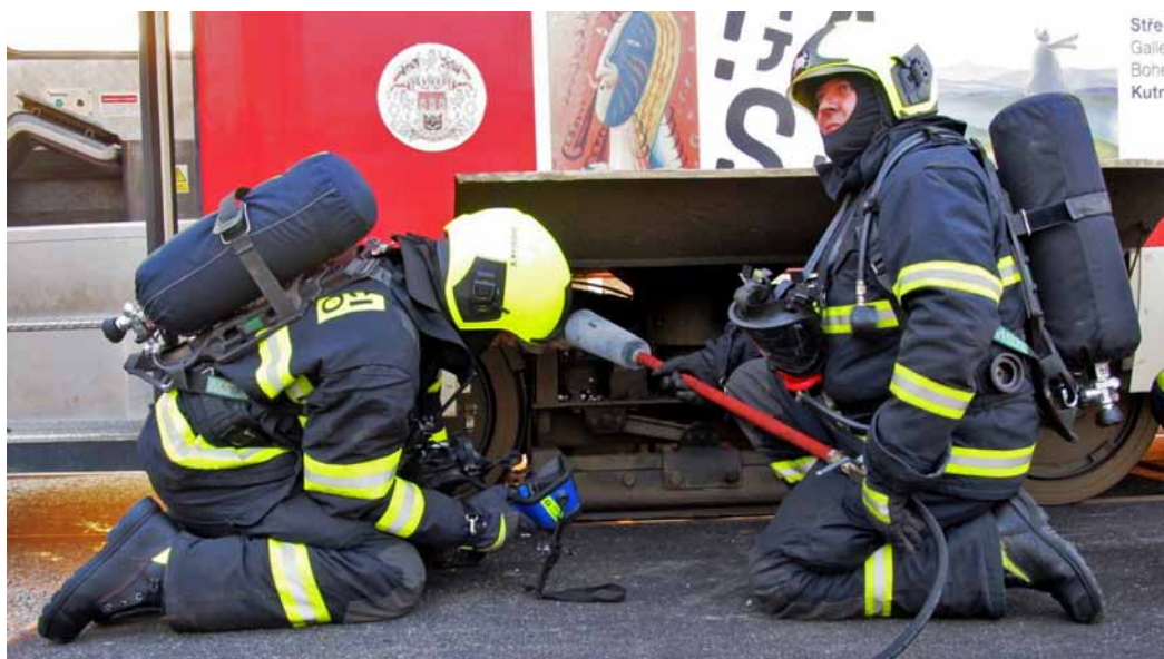
Výjezd č. 273 – dohazování elektroinstalace na podvozku tramvaje T3, smyčka Hloubětín, 16. 7. 2015.
