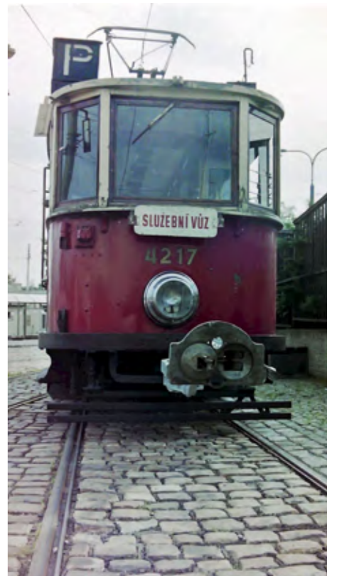
NIC NENAHRADÍ POPISEK K FOTOGRAFII LÉPE, NEŽ OSOBNÍ VZPOMÍNKA ÚČASTNÍKA AKCE, LUĐKA VIDÍMA: „V DEN SLOŽENÍ LOKOTRAKTORU BYL PŘIPRAVEN SLUŽEBNÍ VŮZ 4217 NA POSUN TRAKTORU DO HALY. BOHUŽEL TO NAKONEC ÚPLNĚ NEVYŠLO, PROTOŽE SPŘÁHLO NA LOKOMOTIVĚ MĚLO PŘÍLIŠ MALOU VÝKVNOST DO STRAN, TUDÍŽ MUŠELA BÝT POUŽITA JEŠTĚ JEDNA REDUKCE, KTEROU SE ZVÝŠILA VŮLE VE SPOJENÍ. NAKONEC SE VŠAK PAVEDLO LOKOTRAKTORU ZASUNOUT DO HALY A ČASEM SE DOPLNILO JEŠTĚ TRAMVAJOVÉ SPŘÁHLO PŘÍMO NA METRÁČKÝ VŮZ!“ FOTO: LUDĚK VIDÍM
