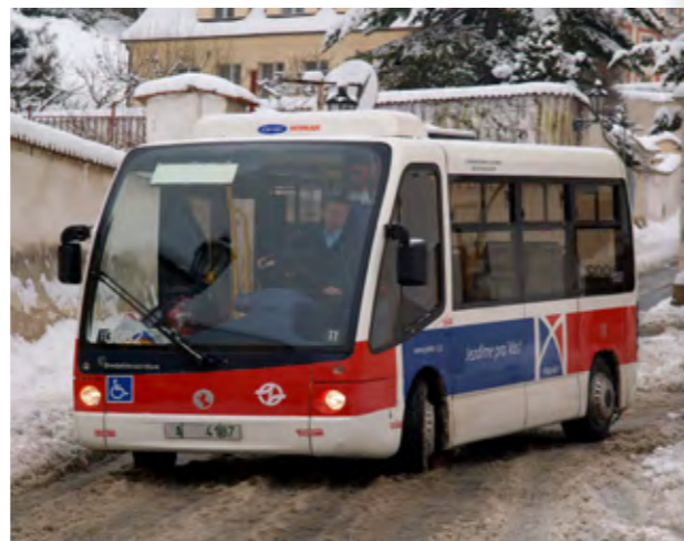
V PRAVIDELNÉM PROVOZU S CESTUJÍCÍMI BYL TESTOVÁN VŮZ BREDA ZEUS S TECHNOLOGIÍ NABÍJENÍ KABELEM (1/2011 – 12/2012)
