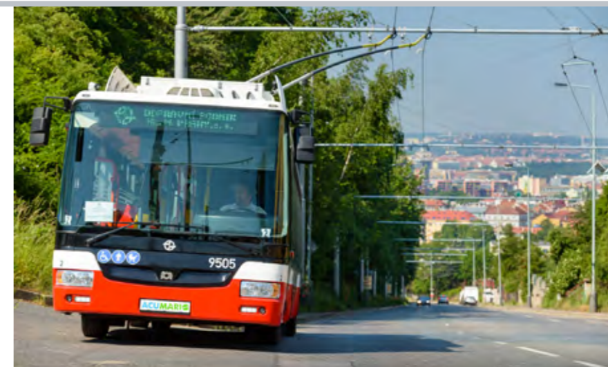
NA ZPROVOZNĚNÉ TRATI V PROSECKÉ ULICI V ŘÍJNU 2017 BYLO NA LINCE 58 TESTOVÁNO NĚKOLIK VOZIDEL S DYNAMICKÝM ZPŮSOBEM NABÍJENÍ, TEDY ZA JÍZDY POD TROLEJÍ, M.J. SOR TNB 12 ACUMARIO
