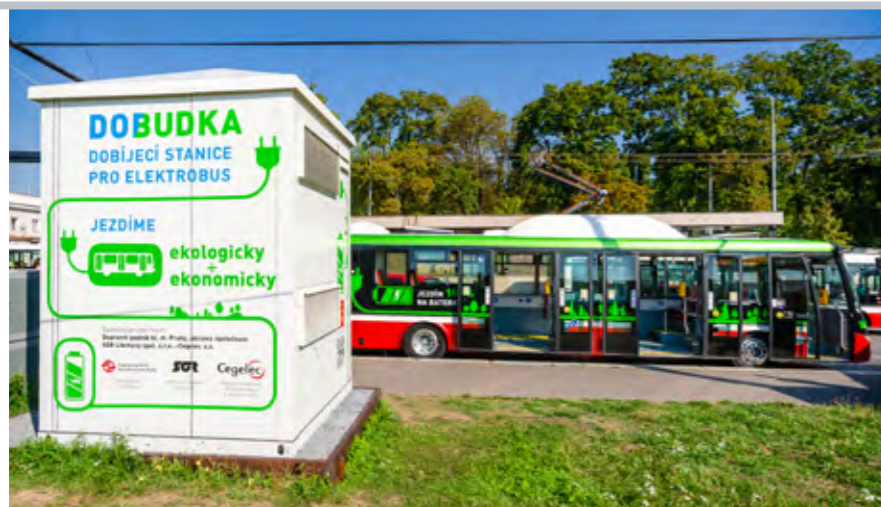
NA LINKÁCH 213 A 163 SE OBJEVIL BATERIOVÝ ELEKTROBUS SOR/SEGELEC EBN 11 DOBÍJENÝ PANTOGRAFEM Z DVOUPÓLOVÉ TROLEJE Z TRAMVAJOVÉ SÍTĚ (9/2015 – 8/2017)
