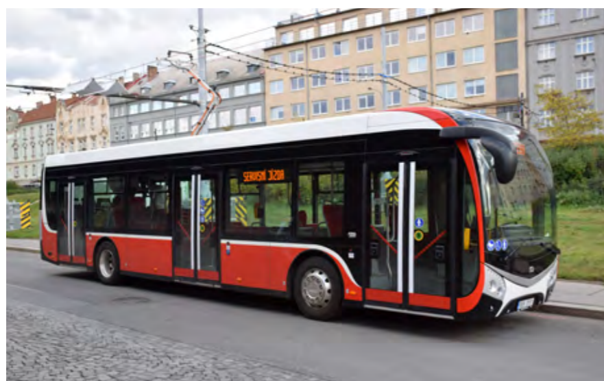
BATERIOVÝ ELEKTROBUS SOR NS 12 TESTOVÁN NA LINCE 109, OPĚT DVOUPÓLOVÝ SYSTÉM PŘES STACIONÁRNÍ GALVANICKÉ ODDĚLOVACÍ ZAŘÍZENÍ, Tzv. DOBUDKU (OD 10/2017)
