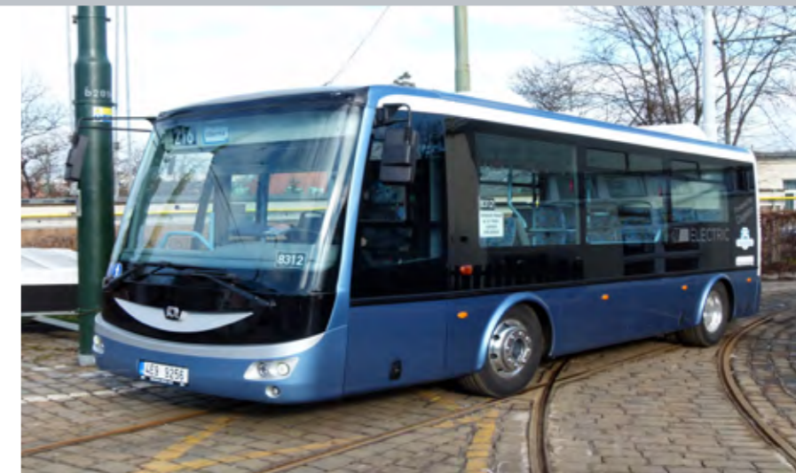
NA LINCE 216 PROBÍHALO OVĚŘOVÁNÍ VOZU SOR EBN 8 NABÍJENÉHO KABELEM (2/2014)
