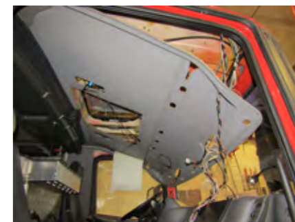
ÚPRAVA ELEKTROINSTALACE V RÁMCI VÝMĚNY SVĚTELNÝCH VÝSTRAŽNÝCH ZAŘÍZENÍ FOTO: ANZA
