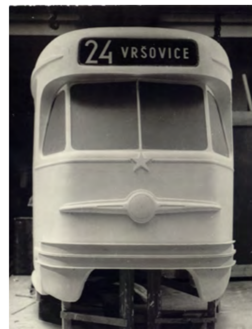
KONEČNÁ VARIANTA SÁDROVÉHO MODELU PŘEDNÍHO ČELA TRAMVAJE T2 ZHOTOVENÁ FRANTIŠKEM KARDAUSEM V DÍLNĚ SMÍCHOVSKÉ TATROVKY V ROZMEZÍ LET 1952-1953
