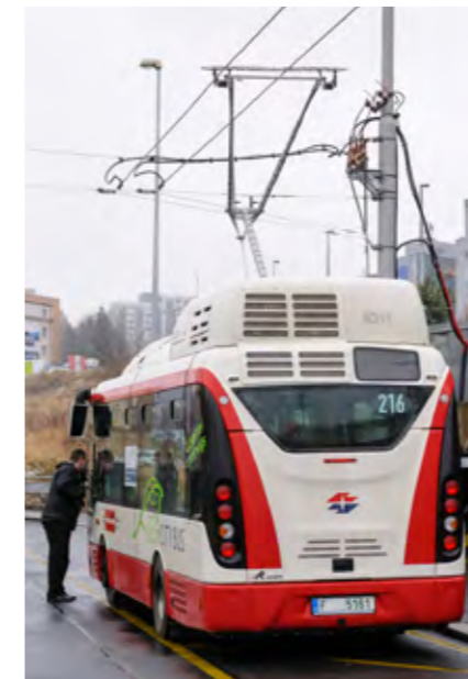
AUTOBUS SIEMENS RAMPINI S NABÍJENÍM Z DVOUPÓLOVÉ TROLEJE NAPÁJENÉ Z TRAMVAJOVÉ MĚNÍRNY (1/2014)
