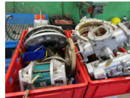
ROZEBRANÉ POŽÁRNÍ ČERPADLO PŘÍPRAVENÉ K OPRAVĚ FOTO: ANZA
