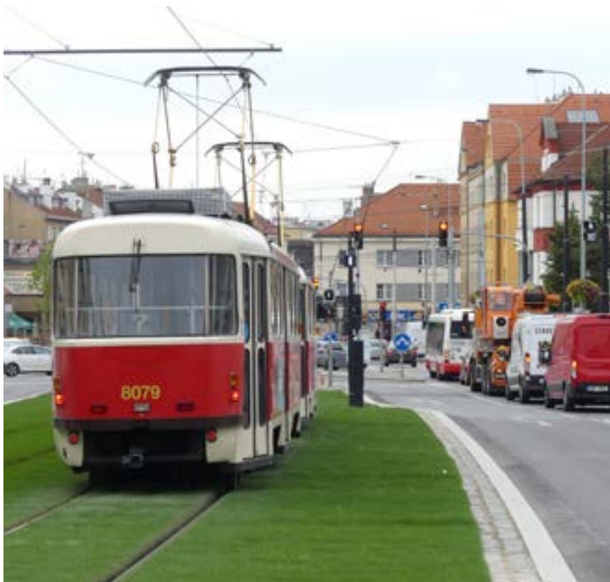
RYCHLOSTÍ 30 KM/H MOHOU TEĎ TRAMVAJE PROJET VÝHYBKU OD STRAŠNICKÉ PŘÍMO DO ZASTÁVKY PRŮBĚŽNÁ. PREFERENCE NA SVĚTELNÉ SIGNALIZACI ZVYŠUJE PRAVDĚPODOBNOST, ŽE SE Podaří NOVINKU NAPLNO VYUŽÍT
