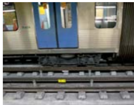
PRO NÁS NEZVYKLÝ POHLED – PŘÍVODNÍ KOLEJNICE BEZ KRYTU S VRCHNÍM ODBĚREM
