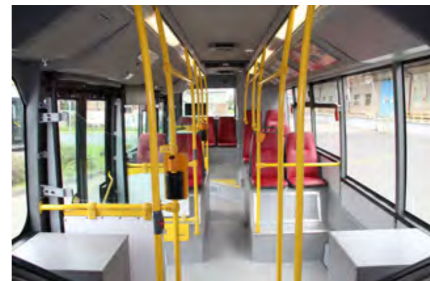
INTERIÉR „PŘIŠEL“ O NĚKOLIK SEDADEL NA ÚKOR VYJÍMATELNÉHO BOXU SE SKLÁDACÍMI ŽIDLÍČKAMI A STOLKY, SKŘÍŇEK NA LETÁKY. NA TYČÍCH NECHYBÍ USB ZÁSUVKY
