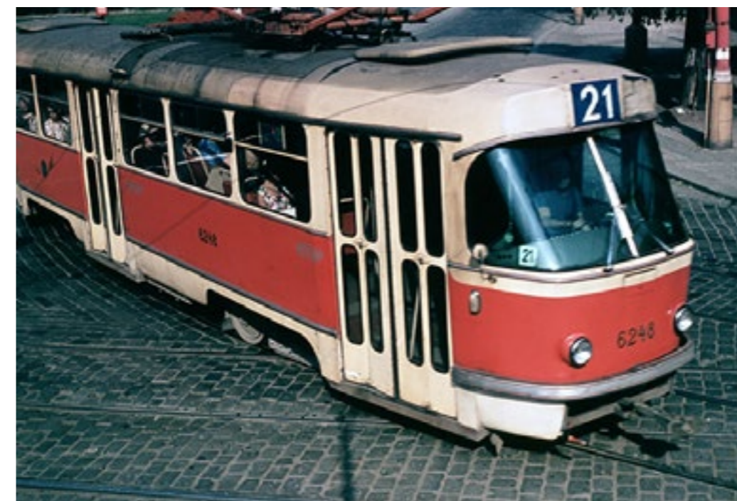
POHLED NA PŘEDNÍ ČELO VOZU Č. 6248 S DETAILEM TVAROVÉHO ŘEŠENÍ A PŘEDEVŠÍM ČERSTVÉ REKONSTRUOVANÉHO INFORMAČNÍHO SYSTÉMU PRO PROSVĚTLOVANÉ MODRÉ TABULE S ČÍSLEM. ČELNÍ TABULE S CÍLOVOU STANICÍ ZAČALY BÝT POUŽÍVÁNY AŽ POZDĚJI. NA SNÍMKU JE VIDĚN I PŮVODNÍ DVOUDÍLNÉ ČELNÍ SKLO BELGICKÉ VÝROBY ČI STŘEŠNÍ VĚTRACÍ KLAPKY FOTO: JAROSLAV KOVÁŘ, ARCHIV DPP
