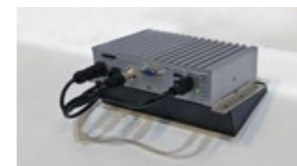
VESTAVNÝ POČÍTAČ PRO SYSTÉMY INFORMACÍ PRO CESTUJÍCÍ A POČÍTÁNÍ CESTUJÍCÍCH V KOLEJOVÝCH VOZIDLECH OD FIRMY NEXCOM
