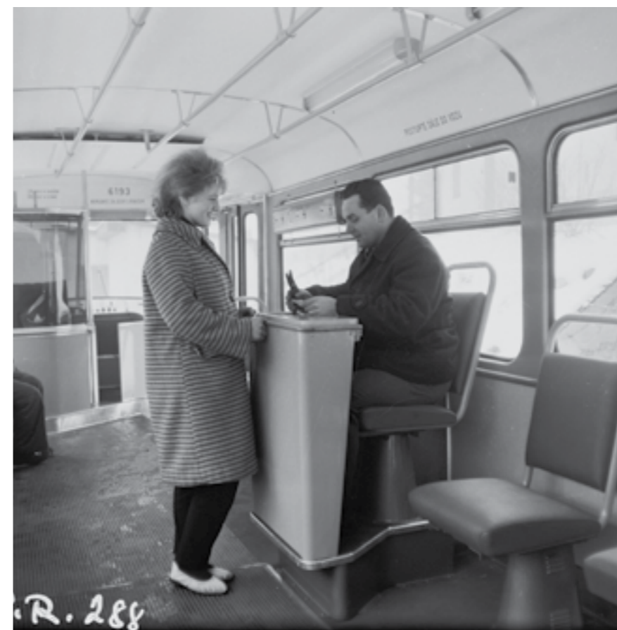
PŮVODNÍ STANOVIŠTĚ PRŮVODČÍHO NA NEJSTARŠÍCH VOZECH T3 BYLO JEN VYVÝŠENOU PLECHOVOU OHRÁDKOU VYBAVENOU ZÁSUVKOU NA PENÍZE A POOTOČENOU SEDAČKOU PRO CESTUJÍCÍ. VŮZ Č. 6193 V ROCE 1963
