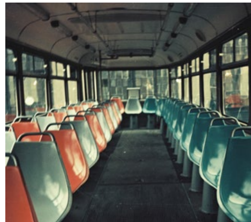
ZKUŠEBNÍ LAMINÁTOVÉ SEDAČKY Z ROKU 1963 BEZ VÝŘEZŮ A VE TŘECH BAREVNÝCH MUTACÍCH, KTERÉ BYLY ZKUŠEBNĚ OSAZENY NA NĚKOLIKA EXPORTNÍCH VOZECH PRO SSSR (NA SNÍMKU) A TAKÉ V PRAŽSKÉM VOZE Č. 6303
