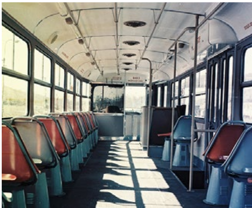
INOVOVANÝ INTERIÉR T3 S LAMINÁTOVÝMI SEDAČKAMI OD MIROSLAVA NAVRÁTILA A ROZŠÍŘENOU VENTILAČNÍ ČÁSTÍ OKEN. EXPERIMENTÁLNÍMI STROPNÍMI VENTILÁTORY BYLA VYBAVENA JEN DESETIKUSOVÁ SÉRIE Č. 6477–6486. NA SNÍMKU NOVÝ VŮZ Č. 6483 V ROCE 1965 FOTO: ČKD PRAHA, SBÍRKA ROBERT MARA
