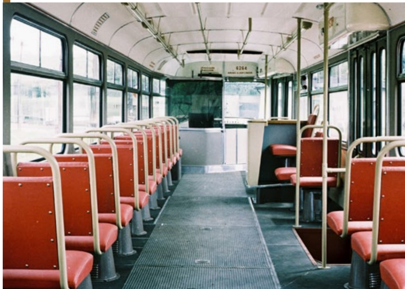
PŮVODNÍ INTERIÉR T3 S ČALOUNĚNÝMI KOŽENKOVÝMI SEDAČKAMI, KTERÉ BYLY MONTOVÁNY DO NEJSTARŠÍCH VOZŮ Z LET 1962 AŽ 1964 (Č. 6102–6323). NA SNÍMKU NOVÝ VŮZ Č. 6264 V ROCE 1963
