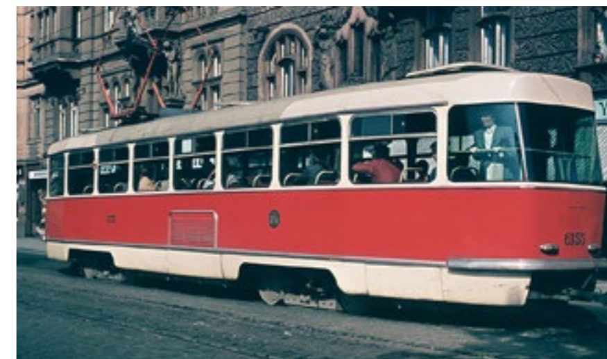
VŮZ T3 Č. 6155 Z PRVNÍ VÝROBNÍ SÉRIE NA LINCĚ Č. 17 NEDALEKO JIRÁSKOVA NÁMĚSTÍ JEŠTĚ V PŮVODNÍM BAREVNÉM PROVEDENÍ S VODOROVNÝMI SDRUŽENÝMI SVÍTLNAMI NA ZADNÍM ČELE. KOLEM ROKU 1965. FOTO: JAROSLAV KOVÁŘ, ARCHIV DPP
