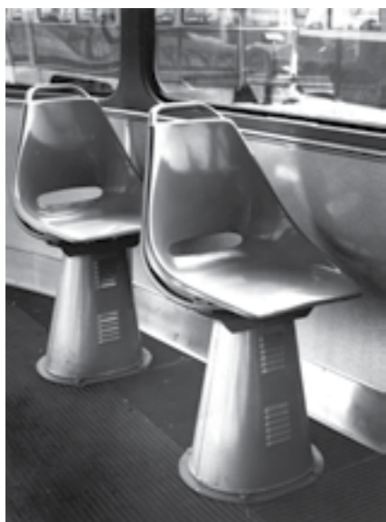
DETAIL LAMINÁTOVÝCH SEDAČEK V PROVEDENÍ MONTOVANÉM NA PRAŽSKÉ VOZY V LETECH 1965 AŽ 1968 FOTO: ČKD PRAHA, SBÍRKA ROBERT MARA
