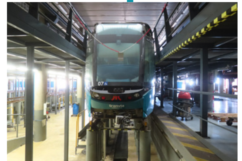
TRAMVAJ EV. Č. 07 NA STANOVIŠTI TZV. TĚŽKÉ ÚDRŽBY VE VOZOVNĚ
