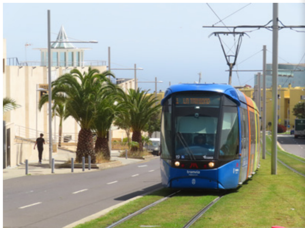
ČELNÍ POHLED NA TRAMVAJ CITADIS 302 V TYPICKÉM USPOŘÁDÁNÍ SEVERNÍ ČÁSTI TRATĚ LINKY Č. 1
