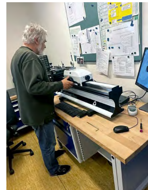
UKÁZKA DIGITÁLNÍHO DÉLKOMĚRU SE SOFTWAREM ZAŘÍZENÍM SLOUŽÍCÍHO JAKO ETALONOVÉ ZAŘÍZENÍ PRO MĚŘENÍ DÉLKOVÝCH MĚŘIDEL NA PRACOVISTĚ Č. 1 – OBOR DÉLKA
