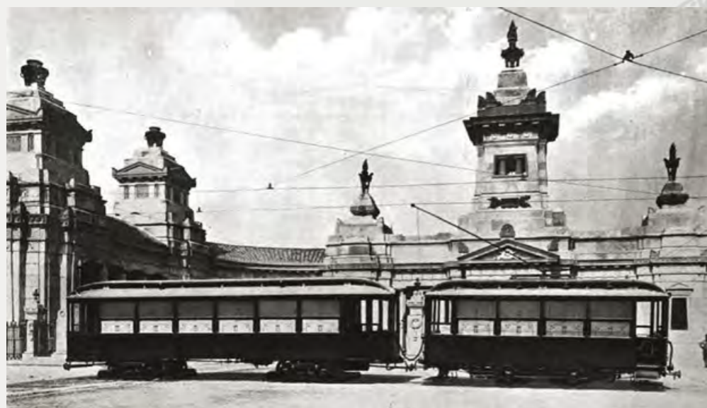
SOUPRAVA POHŘEBNÍ TRAMVAJE SLOŽENÁ Z MOTOROVÉHO VOZU ŘADY 51-64 A ČTYŘNÁPRAVOVÉHO VLEČNÉHO VOZU ŘADY 101-108 ZDROJ: PRIMI TRAM A MILANO, PAOLO ZANIN
