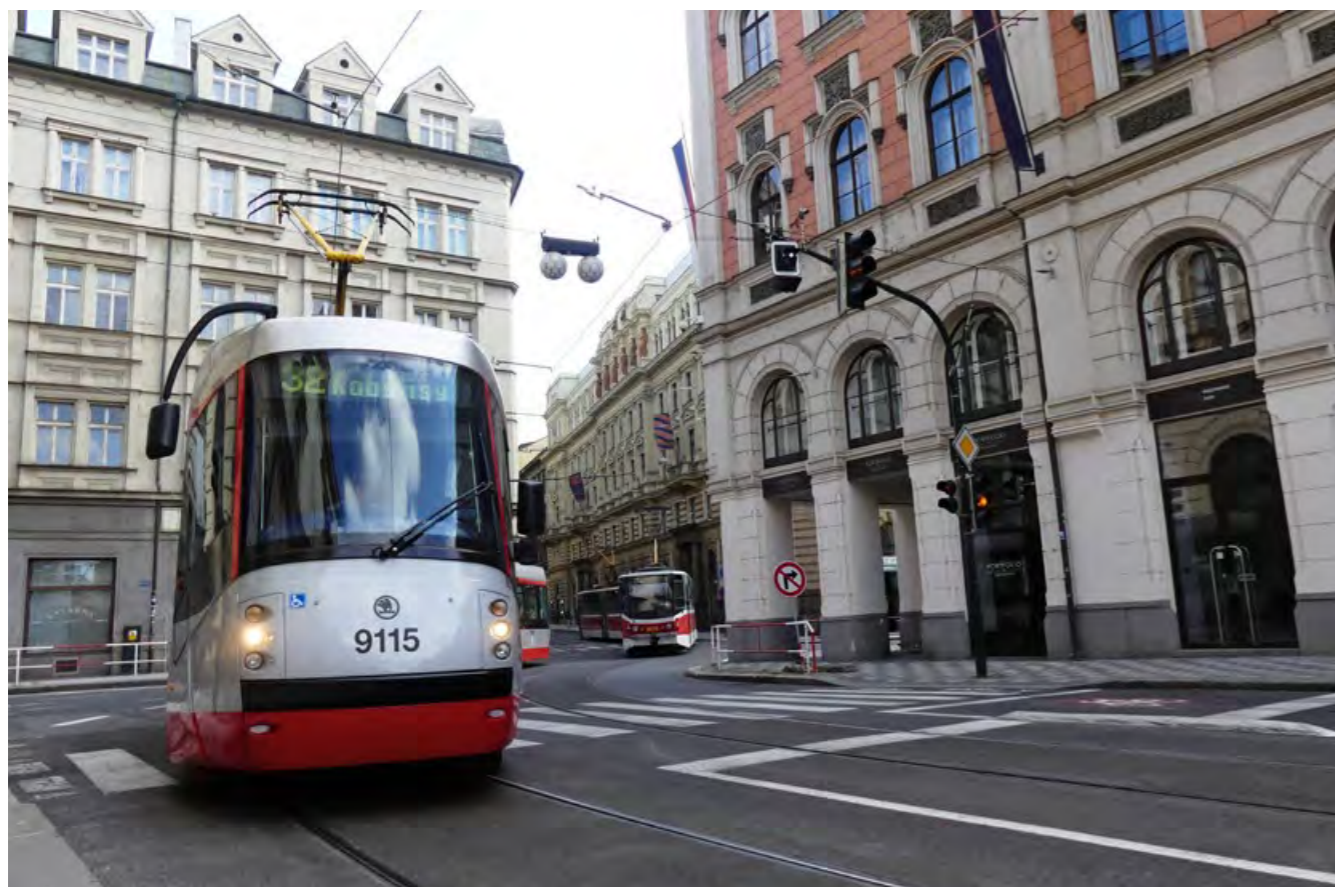
ZVLÁŠTĚ PRO TRAMVAJE 14T NEBYLY TYTO KONTRAOBLUKY PŘES HYBERSKOU ŽÁDNOU SLASTÍ. UPRAVENÁ GEOMETRIE KOLEJÍ PŘINÁŠÍ VĚTŠÍ RYCHLOST I POHODLÍ
