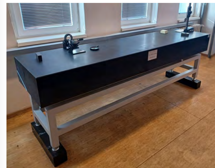
GRANITOVÝ MĚŘICÍ STŮL SE STOJÁNEM POUŽÍVANÝ PŘI KALIBRACI DÉLKOVÝCH MĚŘIDEL (ZEJMÉNA POSUVNÝCH MĚŘÍTEK, MIKROMETRŮ A ROZCHODEK NA MĚŘENÍ VZDÁLENOSTI A VÝŠKY PŘÍVODNÍ KOLEJNICE METRA) NA PRACOVISTĚ Č. 1 – OBOR DÉLKA
