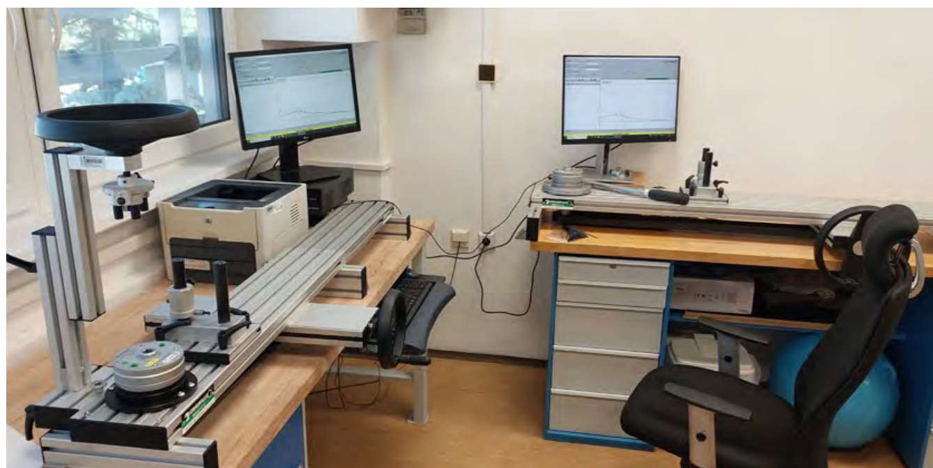
POHLED NA ETALONOVÉ PŘÍSTROJE PRO KALIBRACI MOMENTOVÝCH KLÍČŮ A MOMENTOVÝCH ŠROUBOVÁKŮ NA PRACOVIŠTI Č. 3 – OBOR MOMENT SÍLY
