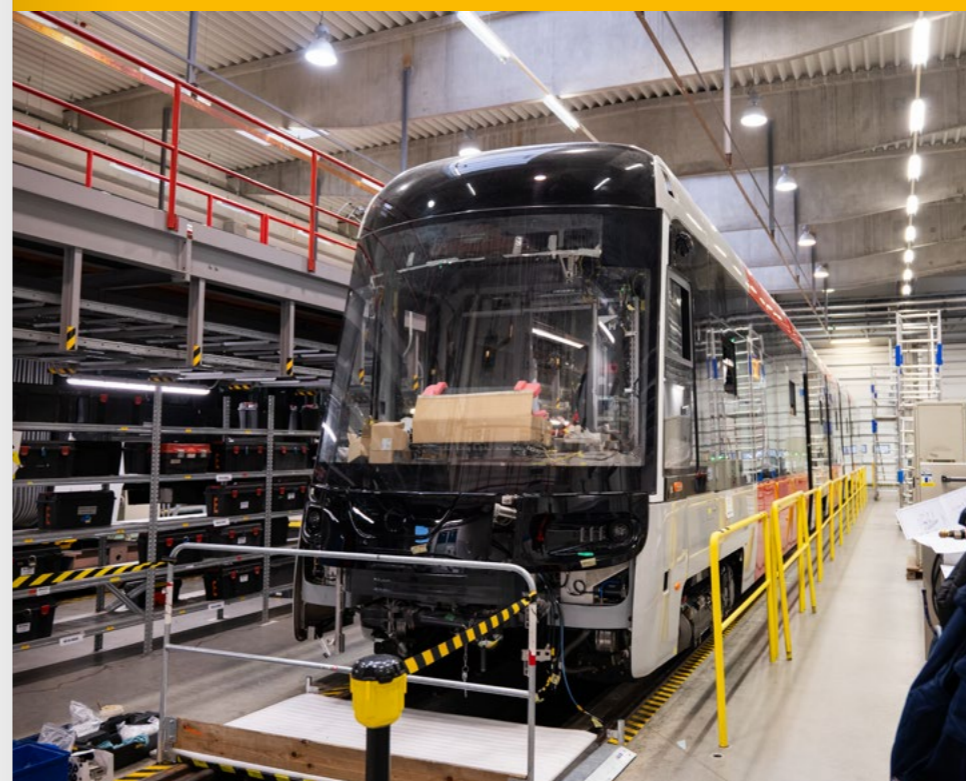
TRAMVAJE 52T NA ZKUŠEBNĚ VÝROBNÍHO ZÁVODU, KDE DOCHÁZÍ K FINÁLNÍ KOMPLETACI A OŽIVENÍ
