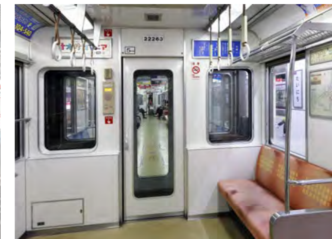
NAPŘÍKLAD VE VLACÍCH ŘADY 20 METRA V ÓSACE MOHOU CESTUJÍCÍ PROCHÁZET MEZI JEDNOTLIVÝMI VAGONY, ZATÍMCO VLAK STOJÍ NEBO I ZA JÍZDY
